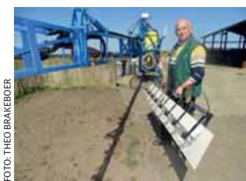
Harrie Hoeben laat zien hoe de Single Wing onder vrijwel ieder type spuitboom kan worden gemonteerd.
